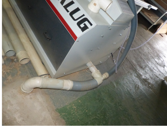
Figura 30 - Tubulação improvisada entre o ventilador e captor de poeira Fonte: arquivo pessoal
