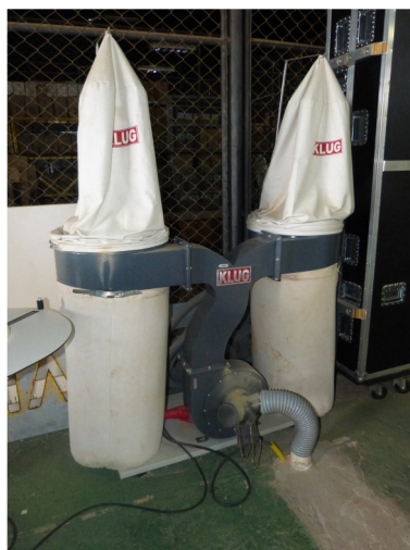
Figura 29 - Conjunto exaustor motoventilador instalado para a seccionadora Fonte: arquivo pessoal
